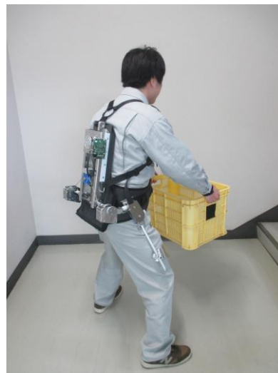
アシストスーツの装着状況
